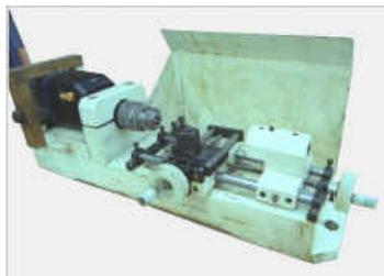
Lorsque l'on dispose d'un mini-tour de fabrication « maison » basé sur l'utilisation d'une perceuse de bricolage, le plus gros problème est certainement le montage de pièces de diamètre supérieur à la capacité du mandrin, en général nous sommes limités à 13mm.
